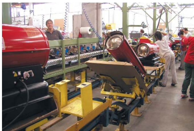
Производственная линия жидкотопливных генераторов горячего воздуха.
