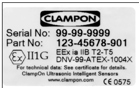
Ярлык 1: Типичная компоновка и размер (50x32 мм), стандартный на всех устройствах стандартов EEx ia и CSA.
