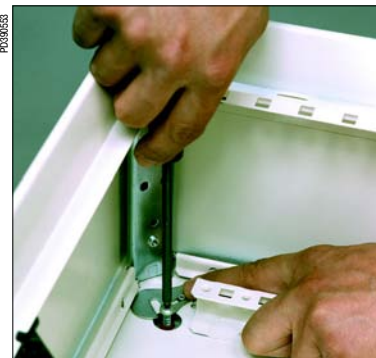
Удобное крепление благодаря специальной системе вильчатого шарнира
