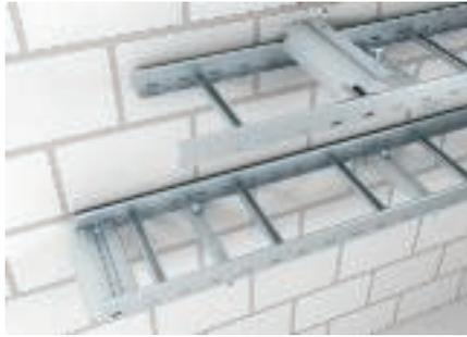
При вертикально отходящих кабелях или проводах используется ответвительная пластина типа LAB для увеличения поверхности прокладки кабеля и в качестве защиты кабеля.
