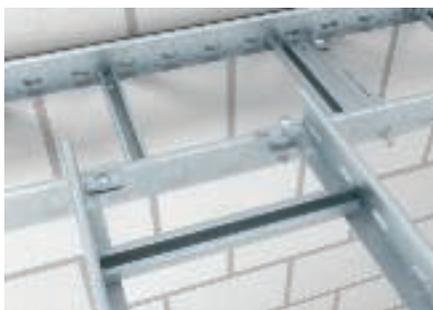
Монтаж горизонтального Т-соединения при наличии двух кабельных лотков лестничного типа, установленных на разной высоте. Для скрепления кабельных лотков лестничного типа требуется опорный уголок типа LAW.
