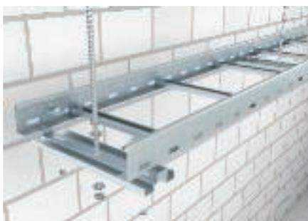
Подвес кабельного лотка лестничного типа с помощью центрального подвеса типа MAHL и резьбового стержня типа 2078/M12.
