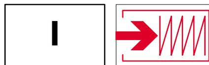
Индикатор положения аппарата остается на "1" (аппарат **включен**).
