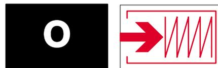
Индикатор положения аппарата остается на "O" (*аппарат отключен*).
