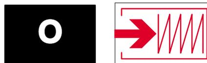
Индикатор положения аппарата остается на "0" (аппарат **отключен**).
