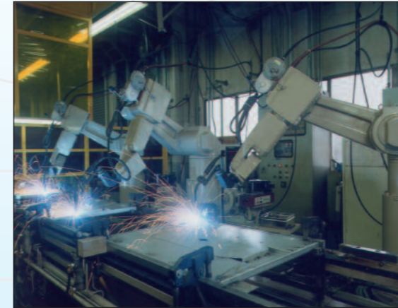
Arc Welding Lichtbogenschweißen
