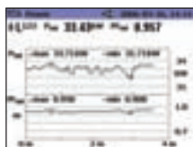
Изучение нагрузки за период 45 дней и просмотр сохраненных данных на дисплее прибора или на компьютере.
