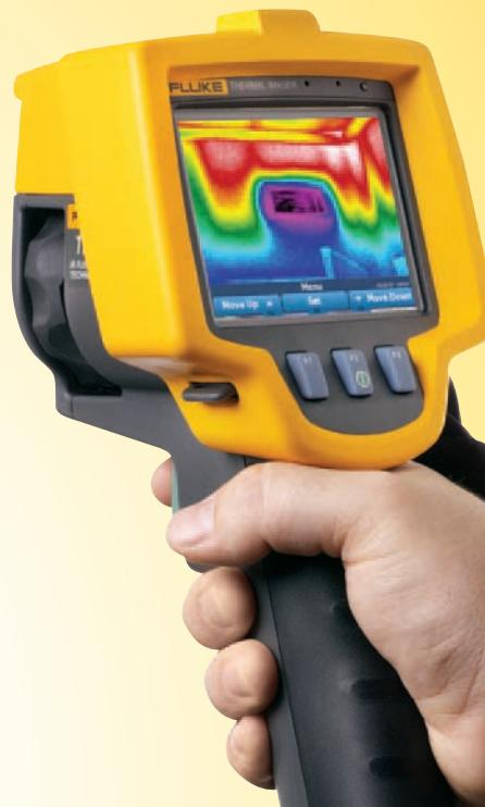
В отличие от обычных цифровых камер, которые получают изображение по отраженному от объектов излучению в видимом спектре, тепловизоры создают изображения благодаря регистрации инфракрасного или теплового излучения. Затем тепловизор отображает цветами разности температур, которые он обнаружил.
