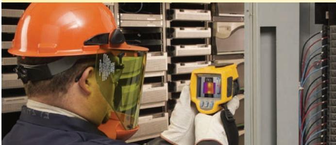
Электрические соединения с ненормально высокой температурой являются не только возможным ранним предупреждением об отказе и угрозе безопасности, но так же потребляют дополнительную энергию.
