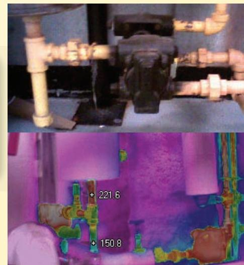
Правильно работающие конденсатоотводчики должны иметь перепад температур между входом и выходом. Высокие или низкие температуры одновременно и на входе, и на выходе, могут означать, что конденсатоотводчик заблокирован в открытом или закрытом состоянии. Необходимо убедиться, что конденсатоотводчик только что переключился, что так же может свидетельствовать о его неисправности.
