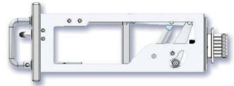
••• Рис. 8.9. Выдвижной модуль в положении «включен и заблокирован»
