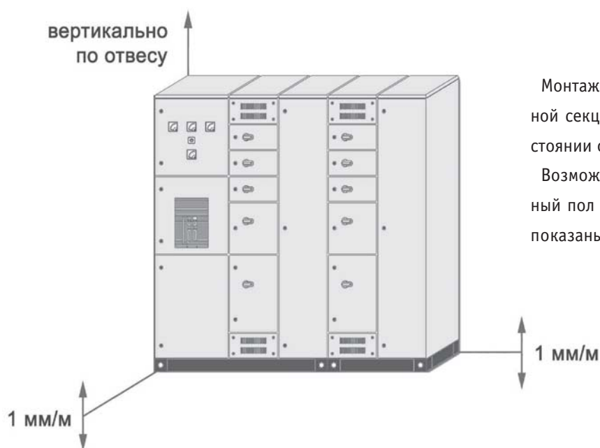
Рис. 3.7. Допустимые отклонения при монтаже НКУ
