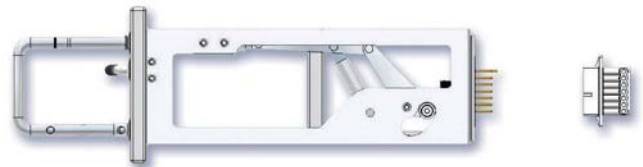
••• Рис. 8.12. Положение выдвижного модуля «извлечен»
