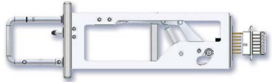
••• Рис. 8.10. Выдвижной модуль в положении «проверка»
