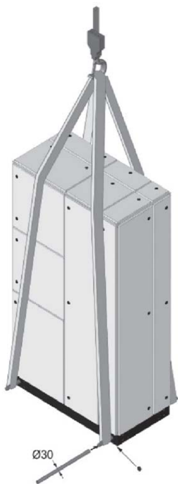
••• Рис. 3.11. Пример строповки шкафа НКУ
