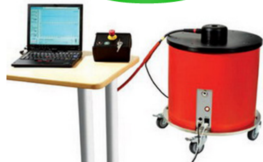
Рис 6. Система диагностики и локализации мест повреждения кабельных линий методом измерения частичный разрядов
