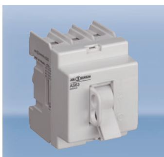
Выключатель 3-пол. 63 А 415 В~ Вводной выключатель, пломбируем в положении «ВКЛ» или «ВЫКЛ», макс. сечение кабеля 25 мм 2
