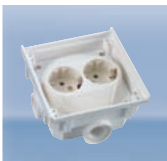
Розетка 1) Термопласт, 4 кабельных ввода с резьбой M20
