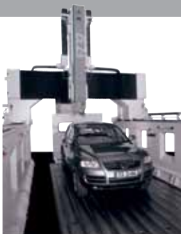
HSC (High Speed Cutting) Portalfräsmaschinen Quelle: F. Zimmermann GmbH
