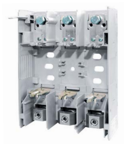
RBK 1 pro VD-M wykonanie do montażu na płycie montażowej, zdjęcie bez pokrywy oraz osłon zacisków, zacisk typu M u góry, zacisk typu V u dołu aparatu lub odwrotnie (RBK 1 pro VG-M)
