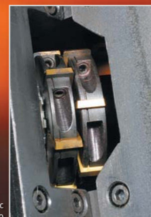
2 фрезероочных диска с 6 режущими пластинами у каждого
