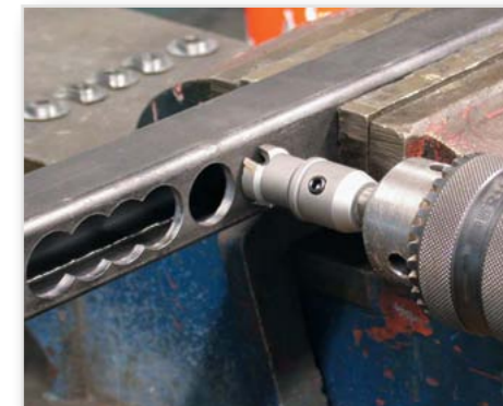
Сверление профиля квадратного сечения
