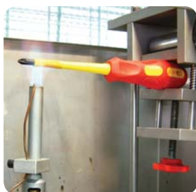
Prova alta temperatura, resistenza alla fiamma High temperature test, material flame retarded test
