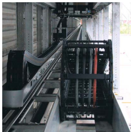
Impianto prova catene/cavi per corse lunghe Lunghezza corsa m 130 Velocità 8 m/s
