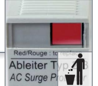
Defekte Module erkennen Sie am roten Sichtfenster. Ein Austausch des Moduls ist erforderlich.
