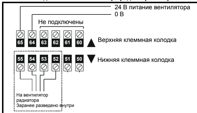
Рис. 5-34 Подключение вентилятора радиатора габарита 6
