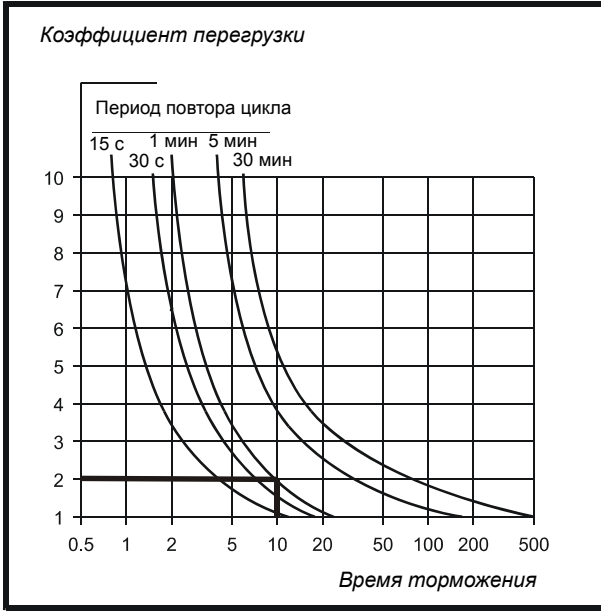
Рис. 5-31 Примеры графиков охлаждения тормозных резисторов (на практике смотрите графики охлаждения используемого резистора)
