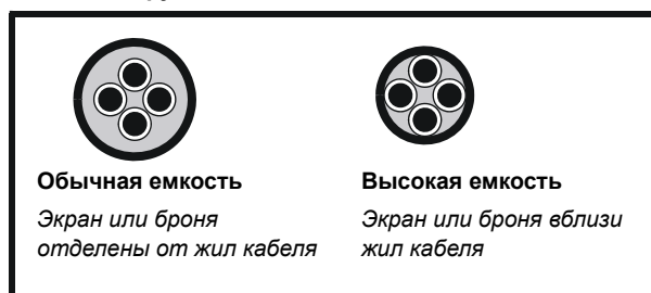
Рис. 8-1 Конструкция кабеля влияет на его емкость
