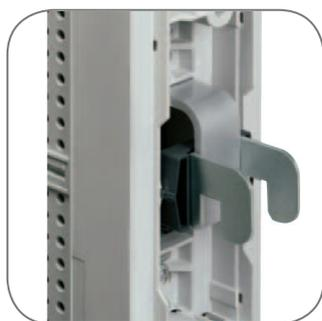
На шине шириной 5-10 мм разъединитель EFEN с контактными крюками монтируется значительно быстрее. При этом не нужно сверлить отверстия. Крюки просто вставляются и фиксируются на своих местах. Крюки используются также, когда на разъединителе установлен трансформатор тока.
