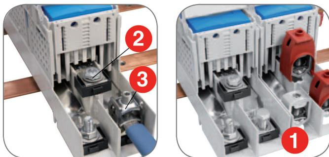
Некоторые предпочитают кабельные наконечники, другим нравится прямое подключение. Новейшая технология поддерживает оба эти варианта. Кабельные наконечники (1) для кабелей сечением до 240 мм² или кабельные зажимы (2) для кабелей сечением до 300 мм² можно крепить винтами в небольшом многофункциональном пластмассовом гнезде (3). Мы положили конец «ячеистой логике».
