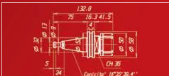
Cono ISO 30 con attacco per pinza ER 32 ISO 30 taper for collet ER 32 Diametro Min. 1 Max. 20 mm./Diameter Min. 1 Max. 20 mm.
