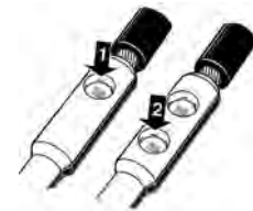
Två pressningar erfordras, dornpressning
