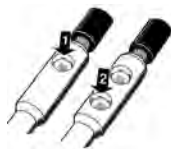
Två pressningar erfordras vid pressning av Al
