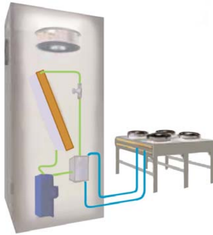
W — с водяным охлаждением конденсатора
