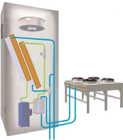
H — Dual-Fluid с водяным охлаждением конденсатора и с использованием охлажденной воды
