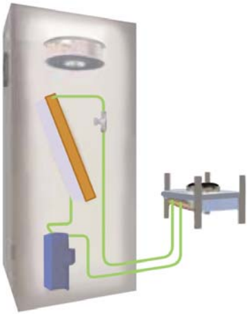
A — с воздушным охлаждением с выносным конденсатором
