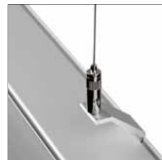
Тросовый подвес и скользящая скоба позволяют регулировать высоту и расстояние между точками подвеса. Легко регулируемый фрикционный замок.
