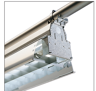
Светильник с 2 лампами с решеткой Profal , установленный на несущую трубу с помощью кронштейна 91198 для труб \varnothing 45-65 \text{ мм} .
