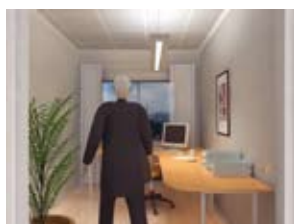
07.56 Светильник включается, улавливая движение, так как дневного света недостаточно для обеспечения нужной освещенности.
