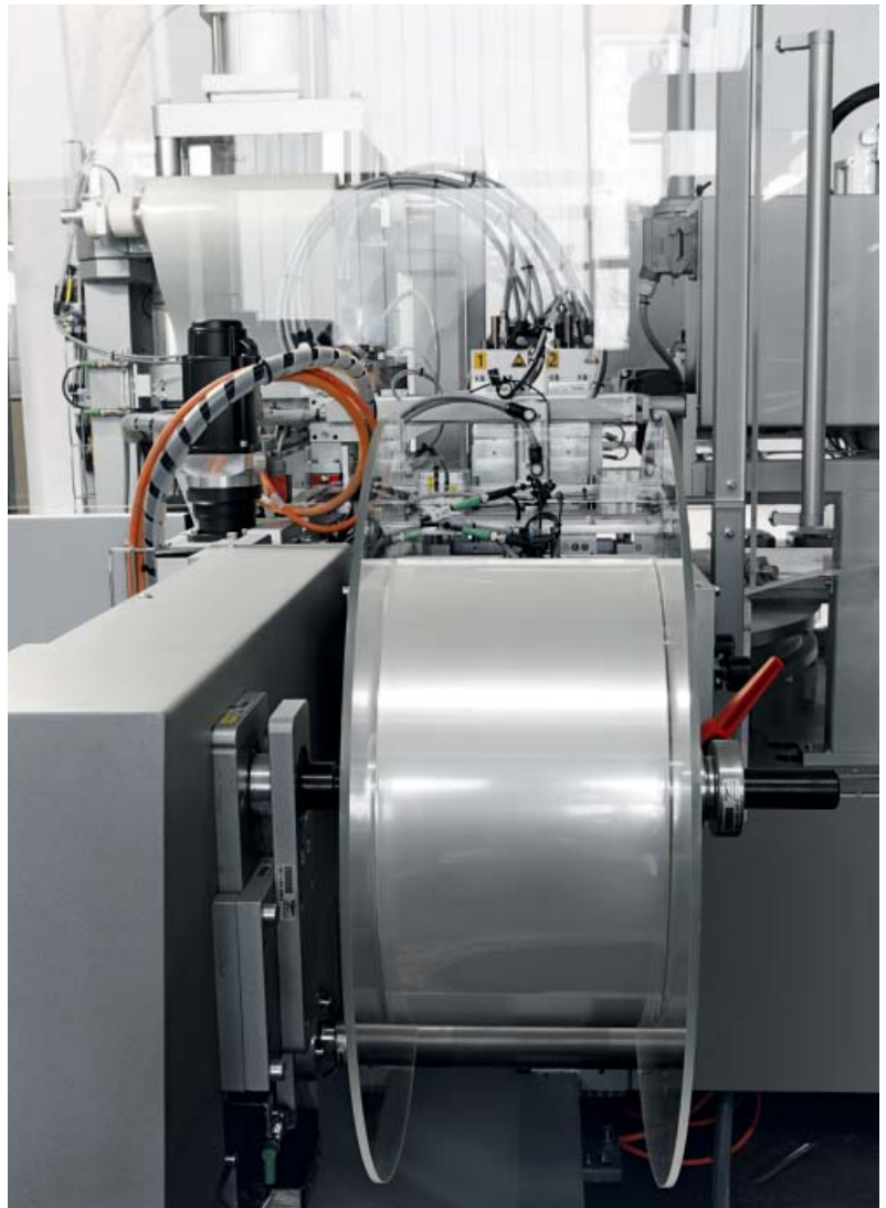
Специалист в ультразвуковой сварке: машины Widmann Maschinen могут работать даже с тончайшей синтетической плёнкой толщиной от 30 мкм.
