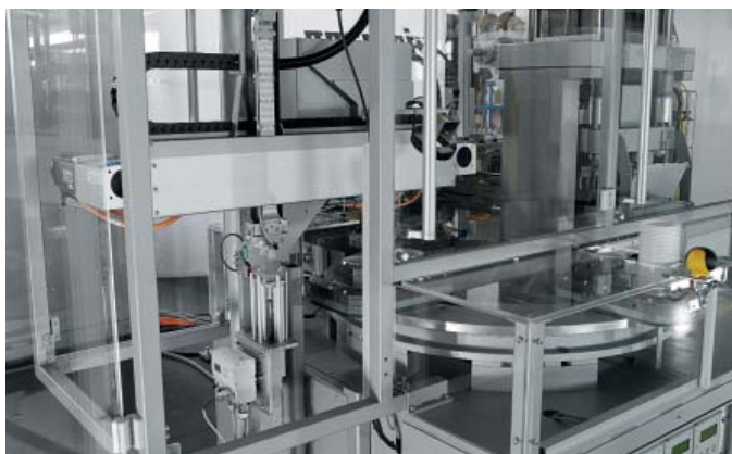
Один взгляд во внутренний мир машины для ультразвуковой сварки. Слева высокоскоростной Т-портал.
