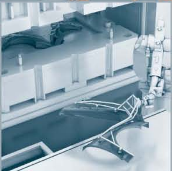
Точный захват и транспортировка штампованных деталей.
