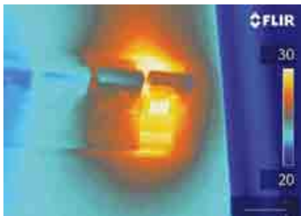
ИК-изображение перегретого предохранителя
