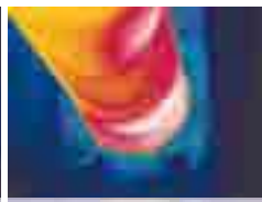
Нарушение футеровки на вращающейся цементной печи
