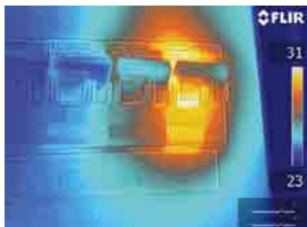
ИК-изображение того же предохранителя с использованием функции MSX. Видно текст ниже предохранителя, что упрощает ремонт нужного предохранителя на более поздней стадии.
