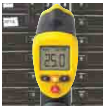
ИК-термометр измеряет температуру в одной точке
