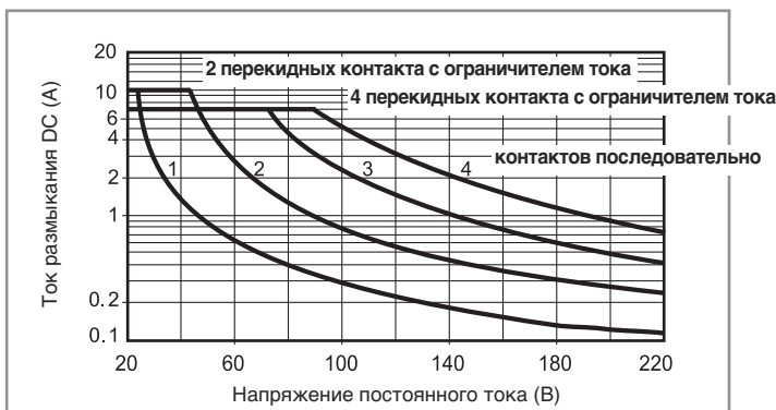
H 59 - Макс. отключающая способность DC1
