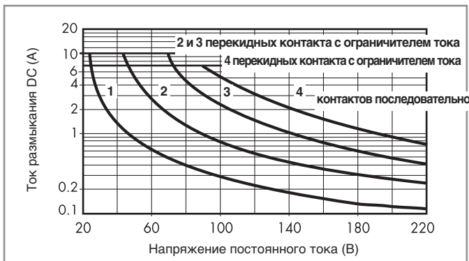
H 58 - Макс. отключающая способность DC1
