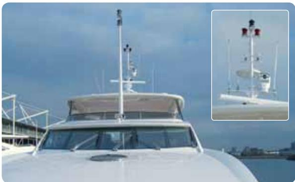
Система FLIR Voyager, установленная на 34-метровой яхте
