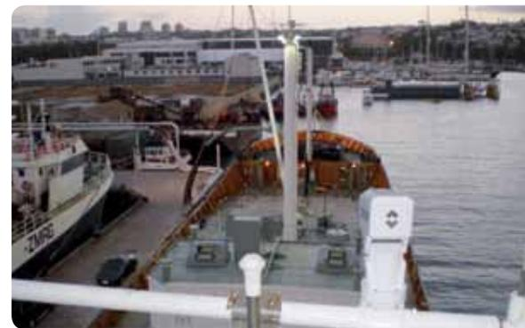
Система Navigator с наклонно-поворотным механизмом от FLIR Systems была установлена над капитанским мостиком на торговом судне Golden Bay. Она помогает экипажу избежать смертельно опасных столкновений.
