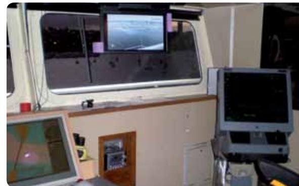
Система Navigator от FLIR Systems создает четкое изображение, которое проектируется на 20-дюймовый ЖК-экран, установленный на капитанском мостике
