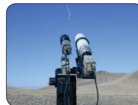
Опорно-поворотные устройства FLIR автоматически отслеживают траекторию полета ракеты на испытательном полигоне
