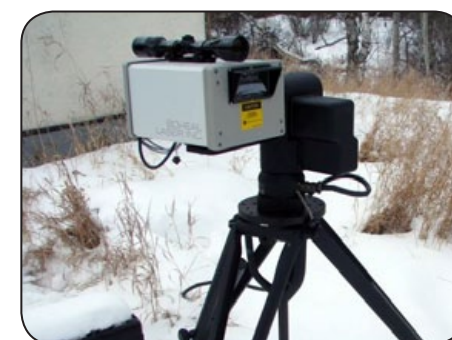
Опорно-поворотные устройства FLIR автоматически отслеживают траекторию полета ракеты на испытательном полигоне
