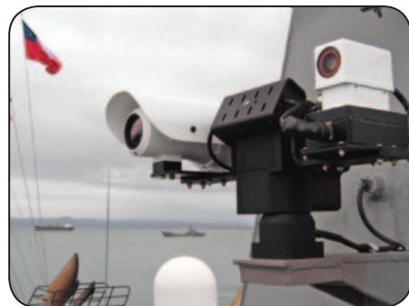
PTU-D300-ISM позиционирует блок оптического сопровождения цели на судне чилийского военно-морского флота.
