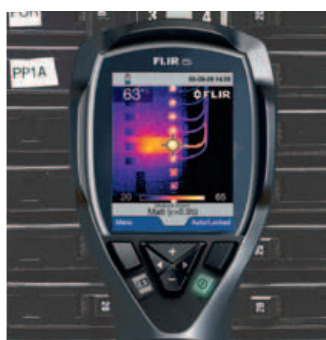
FLIR i3 измеряет температуру в 3 600 точках
