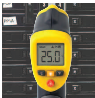
ИК-термометр измеряет температуру в одной точке
