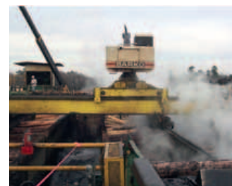
Операторы не могут видеть сквозь облако пара, возникшее из-за конденсации в воздухе более низкой температуры
