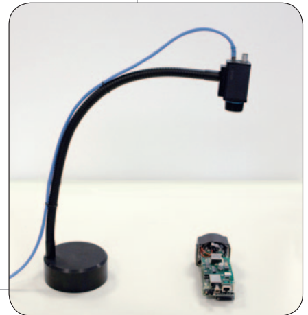
Камера Ax5 на подставке, с использованием S-образной стойки, которая включена в комплект SCxx.
