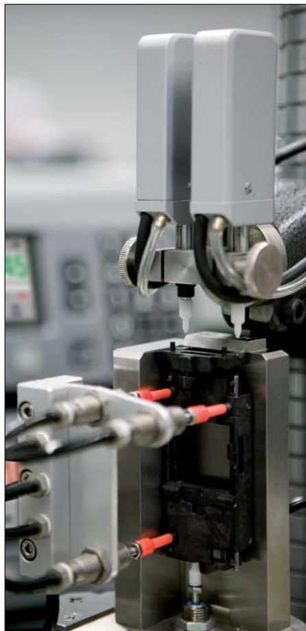
Определение координаты на X-Y-стole для монтажа линз
