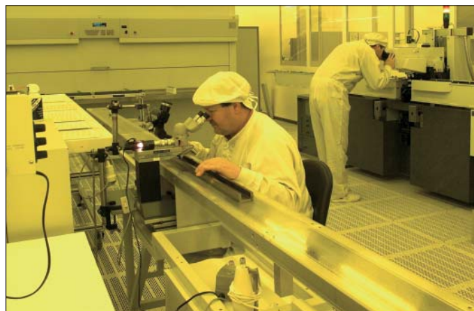
Контрольный пункт проверки шкал в отделе литографии
