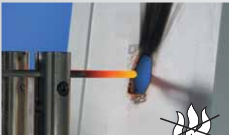
■ Brennverhalten Glühdrahtprüfung nach IEC 60 695-2-11: 750 °C, schwer entflammbar, selbstverlöschend
