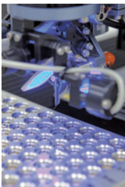
Производство: кремниевые сенсоры давления
