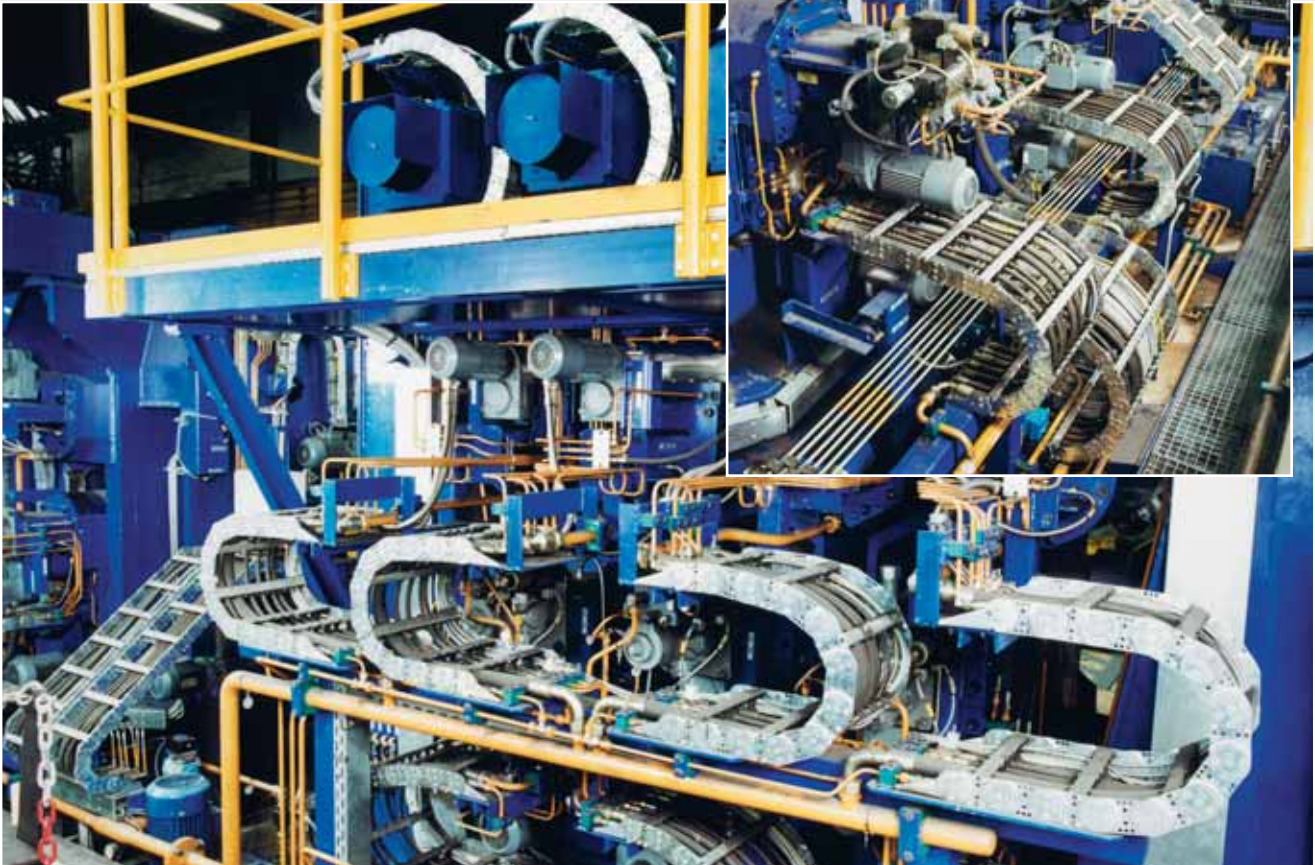
Energieführungsketten aus Stahl an einer Profilrichtmaschine. Fotos: Sondermaschinenbau Wildau GmbH & Co. KG
