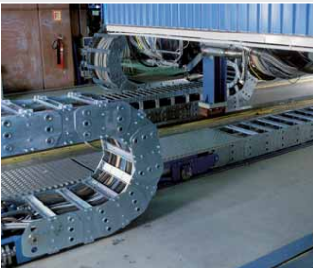
Energieführungsketten aus Stahl mit Energieführungsketten aus Kunststoff zur Separierung der Leitungen an einem ZEUS-Detektor. Foto: Deutsches Elektronen-Synchrotron, Hamburg
