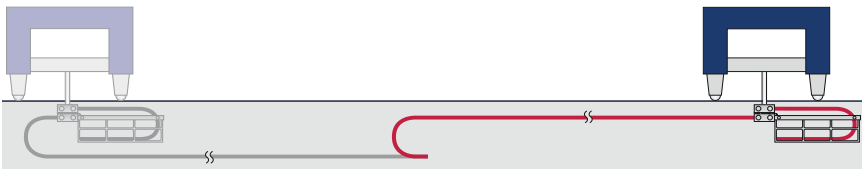
■ Emergency Cable Carrier als Rail Cable Carrier. Das System kann aber ebenso auf gleitende Anordnungen adaptiert werden.
