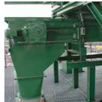
■ Kratzerförderer zur Verteilung verschiedener Spanmaterialien
