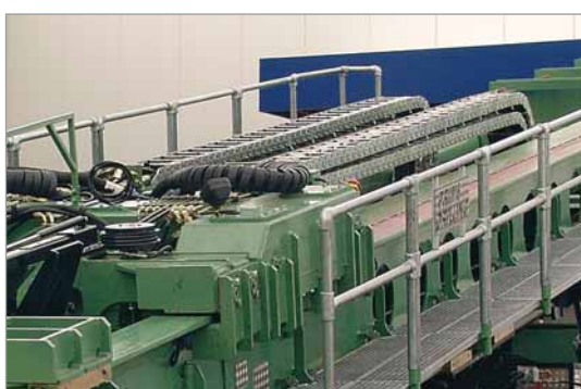
Energieführungsketten aus Stahl an einer Bohranlage Foto: Prime Drilling GmbH
