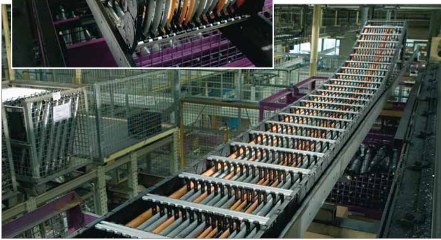
Energieführungsketten der M-Serie an einem automatischen Hochregal Fotos: BMW AG
