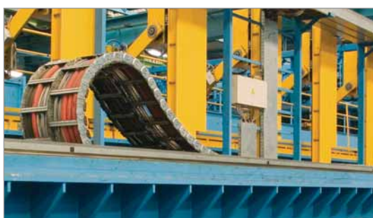
Energieführungsketten aus Stahl an einer Laserschneidemaschine Fotos: Meyer Werft GmbH
