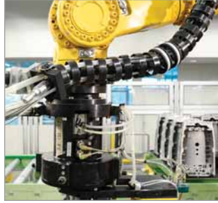
Energieführungen ROBOTRAX an einem Knickarmroboter Fotos: Daimler Chrysler AG
