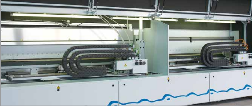
Energieführungsketten der UNIFLEX-Serie an einer Holzbearbeitungsmaschine
