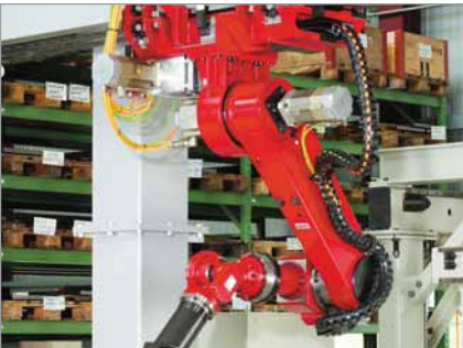
Energieführungssystem ROBOTRAX an einer Portal-, Knickarmroboter-Kombination Fotos: Güdel AG, Langenthal
