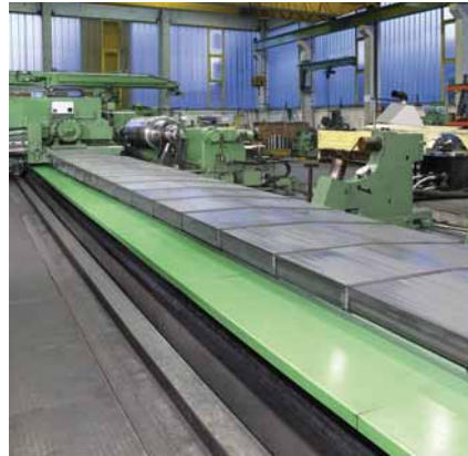
■ Teleskop-Abdeckung an einer Walzenschleifmaschine
