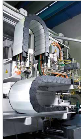
Energieführungsketten der MASTER LT-Serie an einer Rohrenden-Bearbeitungsmaschine Fotos: Rottler Werkzeugmaschinen GmbH
