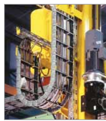
Energieführungssystem ROBOTRAX und Energieführungsketten aus Stahl an einem Manipulator zur Handhabung von Kurbelraumkernpaketen Fotos: Hottinger Maschinenbau GmbH
