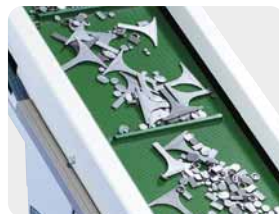
Gurtbandförderer – die Allrounder, auch für scharfkantige Teile
