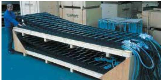
■ Anschlussfertig konfektionierte Energieführungsketten aus Kunststoff, montagefertig verpackt
