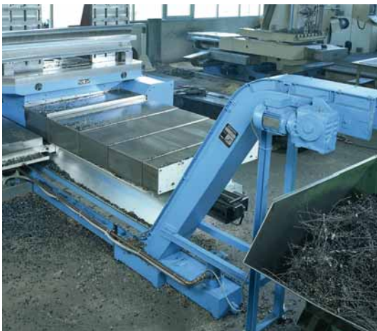
■ Standard-Scharnierbandförderer an einem CNC-Bohrwerk
