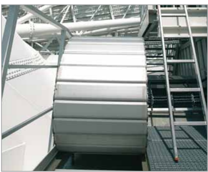
Energieführungsketten aus Stahl an einem Scherenhubtisch Fotos: SÜDO GmbH
