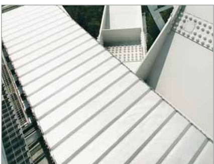
Energieführungsketten aus Stahl mit Aluminium-Deckelsystem an einem Radioteleskop Fotos: Max-Planck-Institut für Radioastronomie
