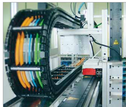
Energieführungs-System QUANTUM an einem Handlingsystem Foto: SEW
