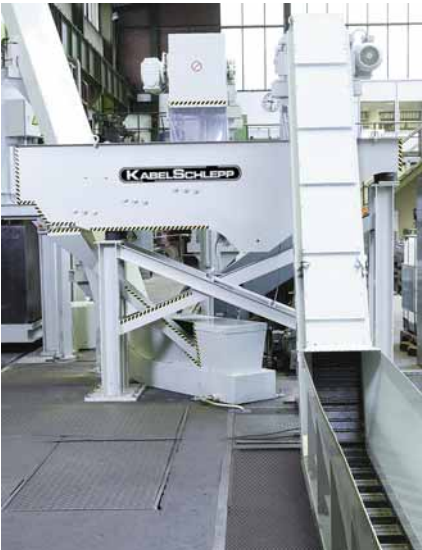
■ Scharnierbandförderer zur Beschickung einer Bunkeranlage
