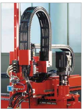
Energieführungssystem QUANTUM an einem Handlingsystem
