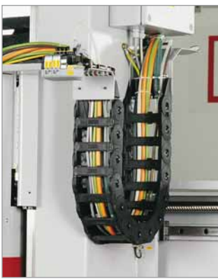
Energieführungsketten der UNIFLEX-Serie an einem CNC- Bearbeitungszentrum Fotos: Reichenbacher GmbH
