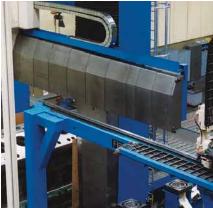
■ Querbalen-Abdeckung an einer Fräsmaschine
