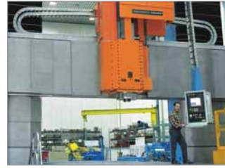
Energieführungsketten aus Stahl und Kunststoff sowie KABELSCHLEPP Teleskop-Abdeckungen an einer Portalfräsmaschine
