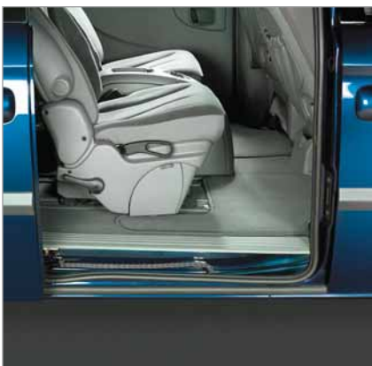
Energieführungsketten Typenreihe 0161 in einer Auto-Schiebetür
