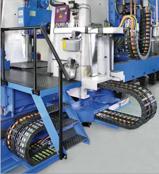
Energieführungsketten der UNIFLEX- und MONO-Serie an einer Walzen-Zapfen-Fräsmaschine
