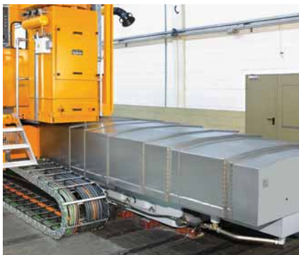
■ Teleskop-Abdeckung an einer Drehmaschine
