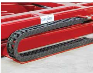
Energieführungsketten der UNIFLEX-Serie an einem Scherenhubtisch Fotos: Grundei Hebetische Verladetechnik GmbH
