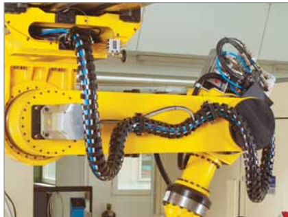
Energieführungssystem ROBOTRAX an einer Portal-, Knickarmroboter-Kombination Fotos: Güdel AG, Langenthal
