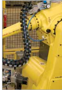
Energieführungen ROBOTRAX an einer Montageanlage Fotos: Gerstung Systemtechnik GmbH
