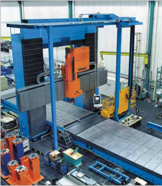
Energieführungsketten aus Stahl und Kunststoff sowie KABELSCHLEPP Teleskop-Abdeckungen an einer Portalfräsmaschine
