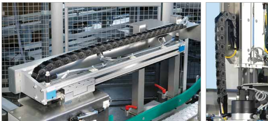
Energieführung der UNIFLEX-Serie an einer Verpackungsmaschine Fotos: Transnova-Ruf GmbH
