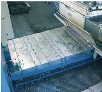
■ Teleskop-Abdeckung mit Flachform an einem Bohnwerk
