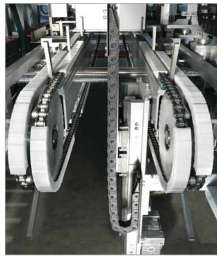
Energieführungen der MONO- und UNIFLEX-Serie an Verpackungsmaschinen
