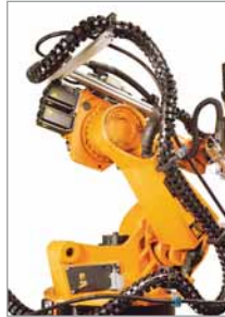
Energieführungen ROBOTRAX an einem Knickarmroboter Foto: SCA Schucker GmbH & Co.
