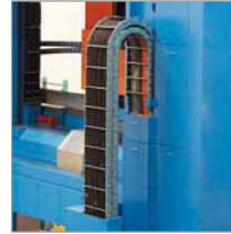
Energieführungsketten aus Stahl und Kunststoff sowie KABELSCHLEPP Teleskop-Abdeckungen an einer Portalfräsmaschine
