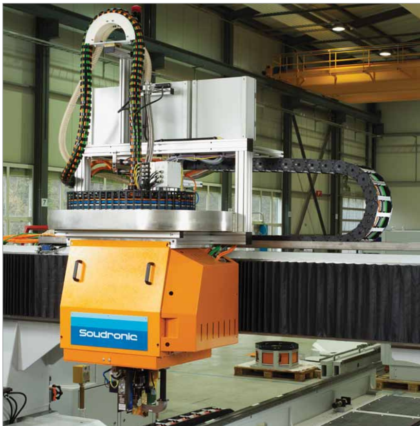
Energieführung ROBOTRAX, K-Serie und M-Serie an einer Laserschneidmaschine Foto: Soudronic AG Automotive
