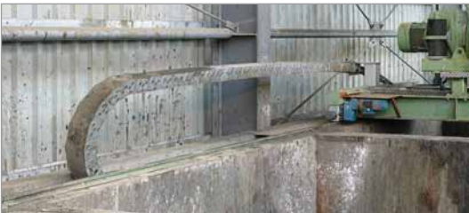
Energieführungsketten aus Stahl mit Stahlbandabdeckung an einer Schredderanlage
