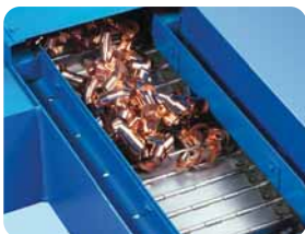
Scharnierbandförderer – bewährt für viele Entsorgungsaufgaben
