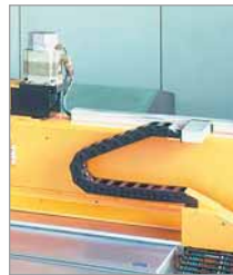
Energieführungsketten der UNIFLEX-Serie und KABELSCHLEPP Teleskop-Abdeckung an einem Hochgeschwindigkeits-Bearbeitungszentrum Foto: EiMa Maschinenbau GmbH
