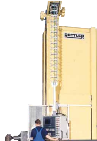
Energieführungsketten aus Stahl an einem CNC-Bohrwerk
