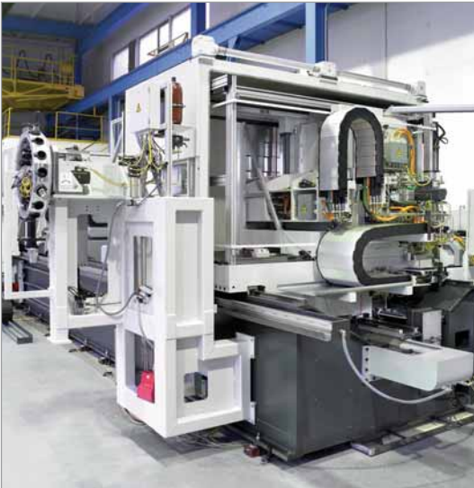
Energieführungsketten der MASTER LT-Serie an einer Rohrenden-Bearbeitungsmaschine Fotos: Rottler Werkzeugmaschinen GmbH
