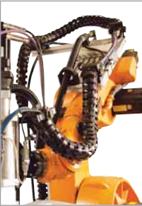
Energieführungen ROBOTRAX an einem Knickarmroboter Foto: SCA Schucker GmbH & Co.
