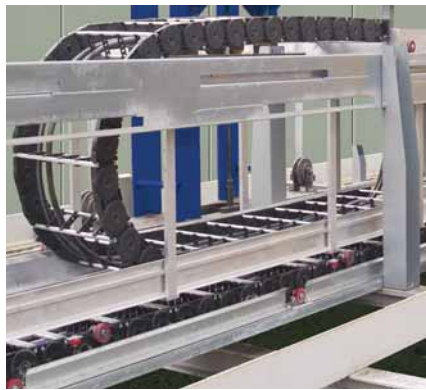
■ Emergency Cable Carrier als Rail Cable Carrier. Das System kann aber ebenso auf gleitende Anordnungen adaptiert werden.
