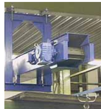
■ Scharnierbandförderer zur Beschickung einer Bunkeranlage
