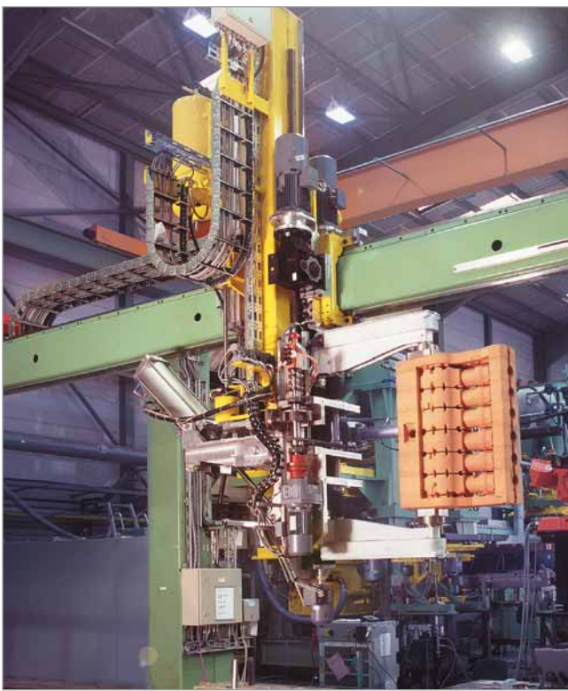
Energieführungssystem ROBOTRAX und Energieführungsketten aus Stahl an einem Manipulator zur Handhabung von Kurbelraumkernpaketen Fotos: Hottinger Maschinenbau GmbH
