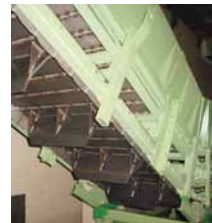
■ Sonderausführung an einer Saumschere mit einer Bandbreite von 900 mm
