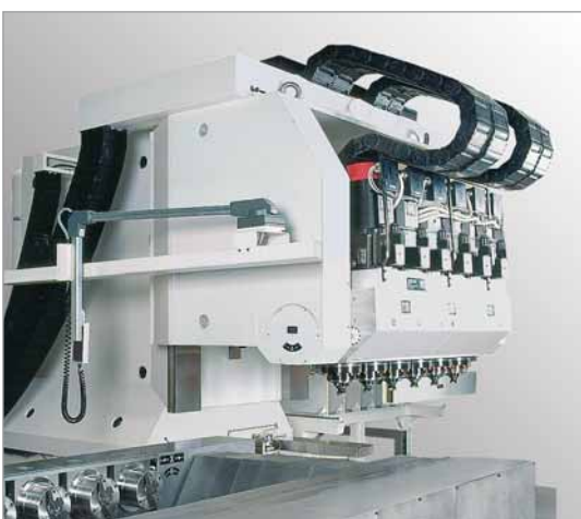
Energieführungsketten der M-Serie an einem Hochleistungs- Bearbeitungszentrum Foto: Liechti Engineering AG
