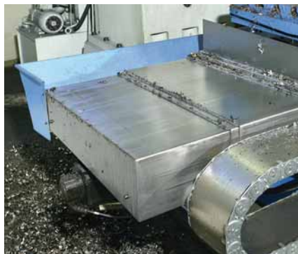
■ Teleskop-Abdeckung an einer Fräsmaschine
