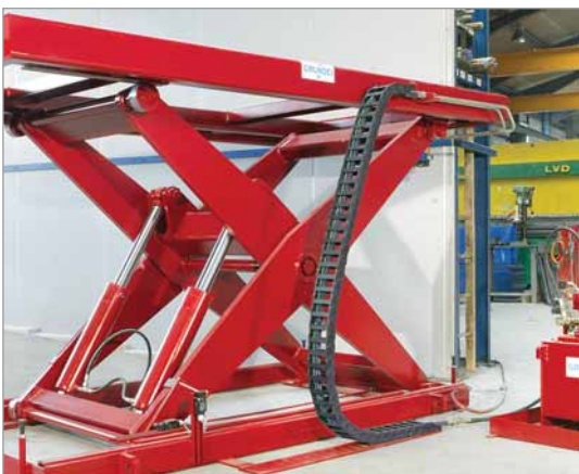
Energieführungsketten der UNIFLEX-Serie an einem Scherenhubtisch Fotos: Grundei Hebetische Verladetechnik GmbH
