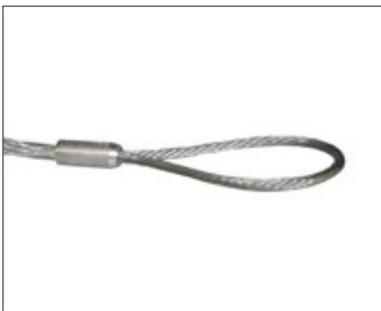
Am Strumpfanfang werden alle Litzen zusammengeführt und in einer Hülse mit einer Seilschleife verpresst. Die Presshülse ist in Zugrichtung großzügig angefast, um ein Verhaken im Rohr zu verhindern.
