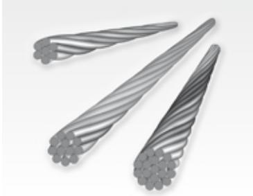
Die Kabelzieh- und Haltestrumpfe von KATIMEX® umschließen das Kabel kraftschlüssig auf der gesamten Geflechtlänge. Sie werden aus zugfesten Stahllitzen hergestellt. Die verwendeten Litzen bestehen je nach Strumpftyp aus 7, 12 oder 19 Drähten. Durch die Auswahl der am besten geeigneten Litze lässt sich die Charakteristik des Kraftverlaufes an die Anforderungen anpassen. Für die Herstellung verwendet KATIMEX® nur hochwertige Materialien aus europäischer Fertigung.
