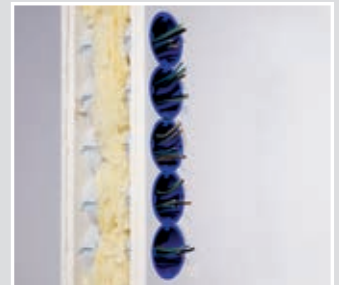
Die Schallschutzdose ist bis zu einer 5-fach-Kombination gegenüberliegend ohne Schwächung des Schallschutzes der Wand einsetzbar.
