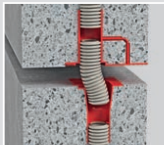
Ausgleich in Querrichtung ± 10 mm.
