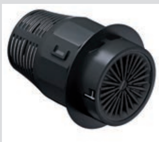
Auf der Innenseite des Schottzylinders angeordnete Lamellen sorgen für ein schnelles Verschließen im Brandfall.
