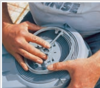
Frontring am Gehäuse einrasten.
