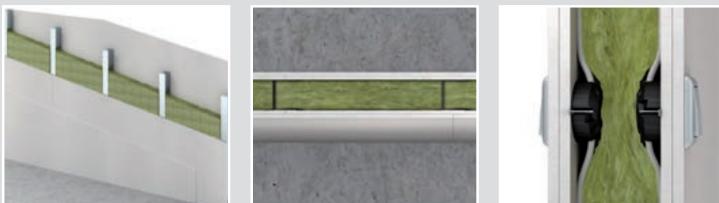
Aufbau einer F90 Metallständerwand nach DIN 4102 Teil 4
