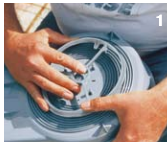
Закрепите фронтальное кольцо на корпусе.
