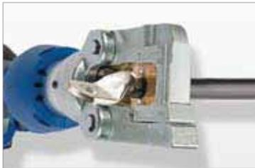
**Высокотехнологичная опрессовка наконечников с усилием 5 тонн:**
