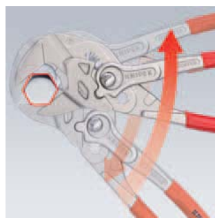
Работы с использованием принципа трещоточного ключа
