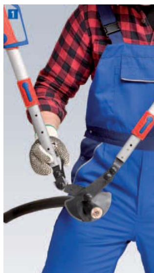
1 Настройка удобного расстояния между ручками
