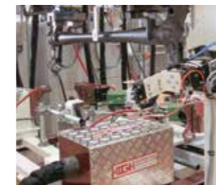
MF Glühstation zur Wärmehandhabung
