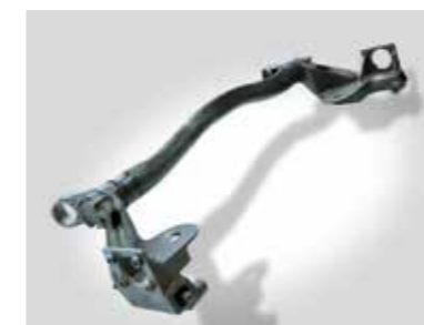
Verbundlenker-Achse (Stahl-Guss) für 4-Rad getriebenes SUV
