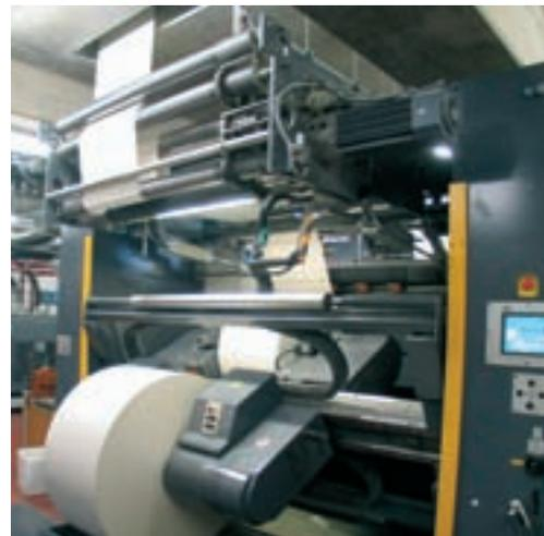
С помощью интеллектуальных сервопреобразователей Lenze с функциями по намотке рулонов возможна комплексная реализация управления намоткой, включая намоточный компьютер с точным предварительным управлением крутящим моментом и числом оборотов в зависимости от степени намотки.
