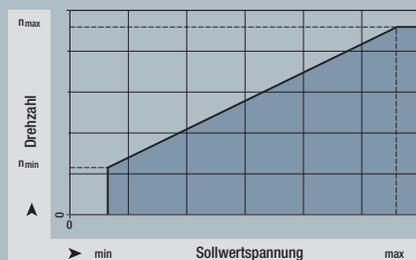
Drehzahlvorgabe zur Drehzahlregelung mittels Sollwertspannung (Schnittstelle 0 ... 10 V DC)
