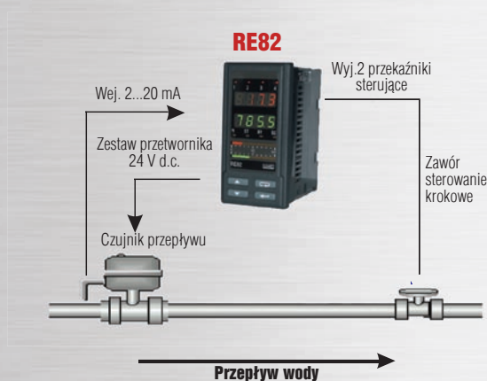
Pomiar przepływu wody ze sterowaniem trójstawnym krokowym
