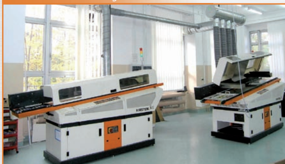
linia lutowania falowego
